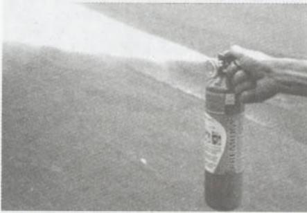
**b) GAS HALON 1211.** Para incendios de tipo A, B Y C. Se identifica por su etiqueta de clasificación y se usa a una distancia de entre 5 y 6 metros del lugar de disparo y se dirige a la base del fuego.
