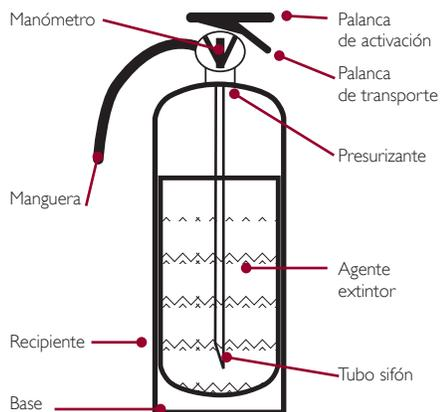
Los extintores se ubican en sitios de fácil acceso y clara identificación, libres de cualquier obstáculo y están en condiciones de funcionamiento máximo. Se colocarán a una altura máxima de 1.30 metros, medidos desde el suelo hasta la base del extintor.
